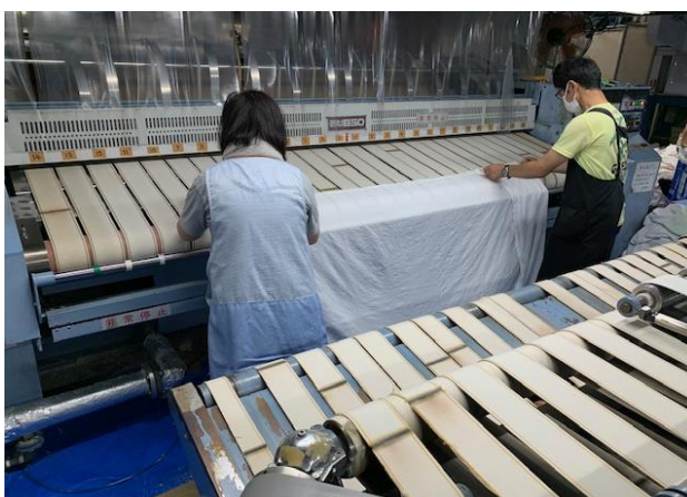
▲シーツロールでの仕上げ作業
